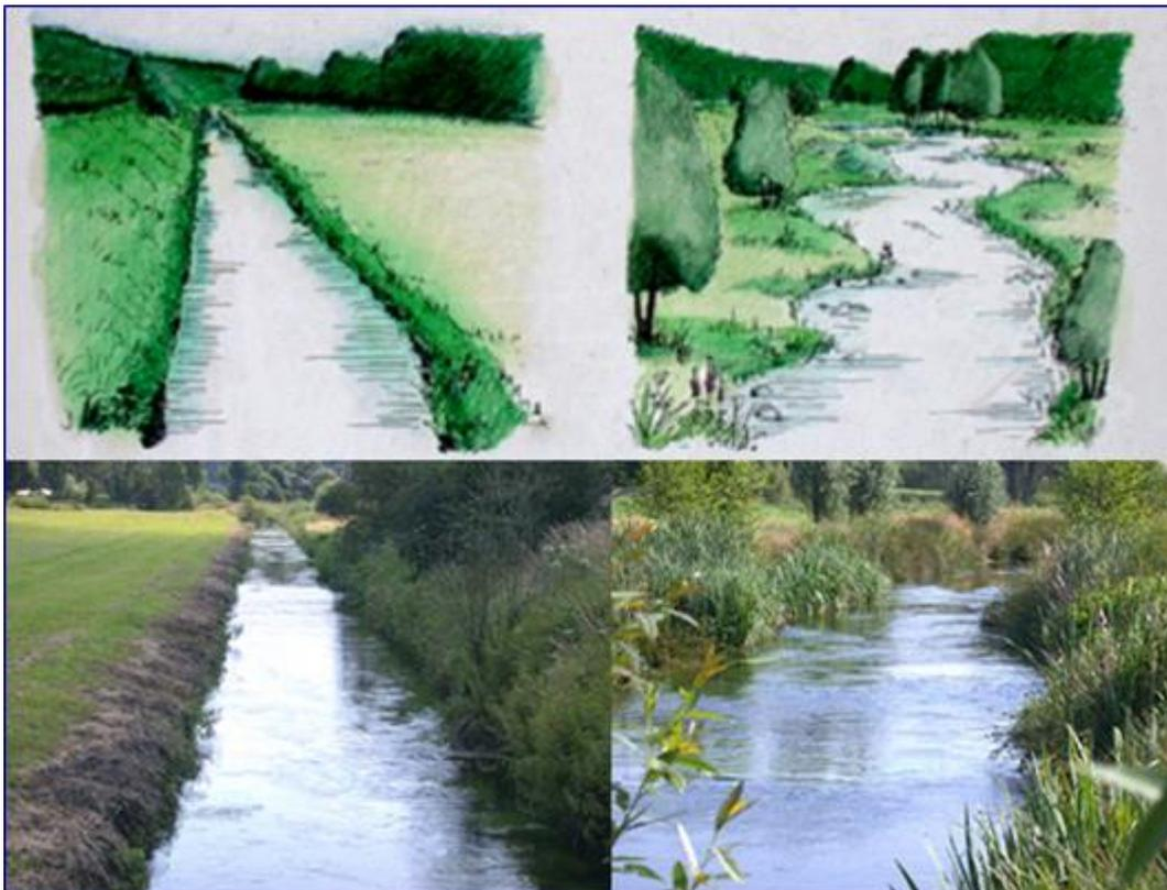
Schemi di riqualificazione di un canale mediante piccolo ampliamento dell'alveo, addolcimento delle sponde e recupero di sinuosità ([www.cirf.org](http://www.cirf.org))
