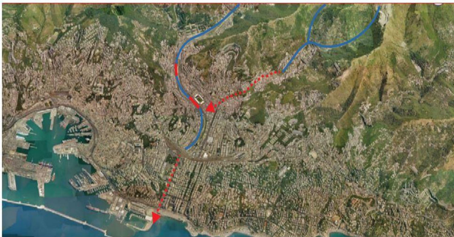
Mappa dei tratti coperti (in rosso) dei torrenti Bisagno e Rio Fereggiano
