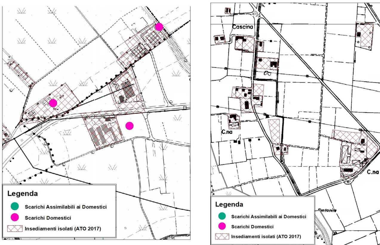
Fig. 1 - Insedimenti isolati con e senza Scarichi di reflui domestici
