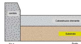
**PAVIMENTAZIONE:** in **calcestruzzo drenante**, resistente ai mezzi pesanti, meno soggetto allo sgretolamento, più duratura. L'elevata porosità consente drenaggio naturale delle acque e il rispetto delle norme sull'invarianza idraulica. La possibilità di scegliere la colorazione della superficie consente di ridurre l'impatto visivo delle infrastrutture nei contesti sottoposti a vincolo ambientale e paesaggistico (es. Parco sud)
