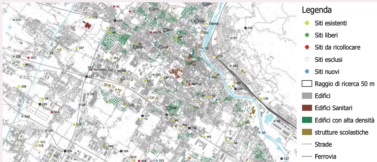
Fig. 7 - Il piano individua cartograficamente i siti da destinare a nuove installazioni, quelli con antenne da ricollocare, i siti esclusi da nuove installazioni.
