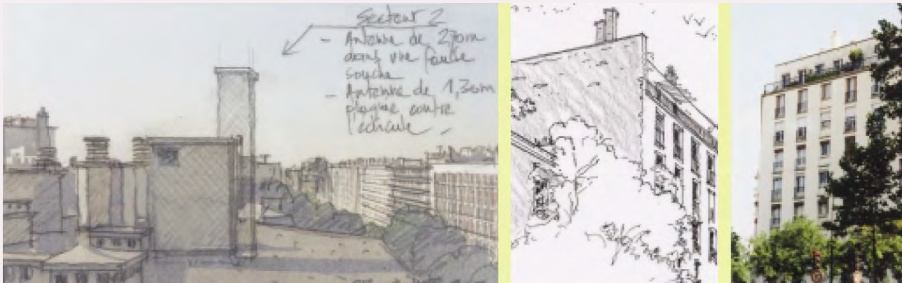
Fig. 62 - Progetto di paesaggio: l'installazione di una nuova antenna richiede un vero e proprio progetto di paesaggio volto a garantirne la maggiore e migliore integrazione possibile con il contesto. Le immagini mostrano la valutazione degli impatti indotti dall'aggiunta ad un edificio esistente di un falso camino a mascheramento di un'antenna per le telecomunicazioni. Gli impatti sono valutati mediante la realizzazione di schizzi commentati. Anche nel caso di installazioni su edifici di recente costruzione i nuovi impianti dovranno rispettare le caratteristiche degli edifici su cui si pongono e tener conto del ritmo di pieni e vuoti, delle scansioni verticali e orizzontali delle facciate dei colori e dei materiali già utilizzati.
