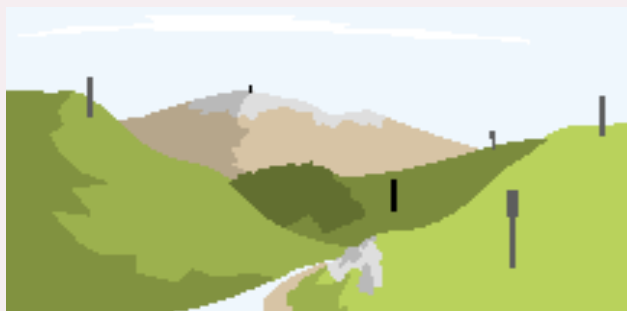
Fig. 71 - Criteri di posizionamento in ambiente rurale: in un paesaggio rurale caratterizzato già dalla presenza di elementi verticali la dispersione dei piloni per le telecomunicazioni può contribuire alla riduzione del loro impatto sul paesaggio. Al contrario in un paesaggio rurale privo di elementi verticali può essere più opportuno concentrare le installazioni. Del resto in un paesaggio aperto l'impatto paesaggistico dei piloni è maggiore che in un paesaggio già movimentato dalla presenza di più elementi. L'installazione in campo aperto, deve evitare di divenire un punto focale di contrasto con lo skyline esistente. Occorre privilegiare le installazioni nelle valli all'interno dei luoghi più montuosi e collinari.
