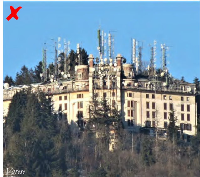
Fig. 34 - Criteri di posizionamento: la scelta della concentrazione o della diffusione di più antenne può derivare soltanto da un'attenta lettura dei caratteri dei luoghi. Certamente la presenza di più infrastrutture tecnologiche diventa di grande criticità in luoghi particolarmente sensibili amplificandone la visibilità. Così, ad esempio, come mostrato nell'immagine del tetto del Grand Hotel Campo dei Fiori, oggi in disuso, ma in posizione di grande visibilità e di riconosciuto valore architettonico e simbolico. Inoltre, le numerose installazioni sull'edificio storico hanno contribuito in maniera sostanziale al degrado della copertura lignea (a causa delle forature necessarie all'ancoraggio di ogni singola antenna) con conseguenze all'intero edificio. (foto: Lionella Scazzosi, varesereport.it)
