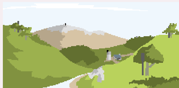
Fig. 71 - Criteri di posizionamento in ambiente rurale: in un paesaggio rurale caratterizzato già dalla presenza di elementi verticali la dispersione dei piloni per le telecomunicazioni può contribuire alla riduzione del loro impatto sul paesaggio. Al contrario in un paesaggio rurale privo di elementi verticali può essere più opportuno concentrare le installazioni. Del resto in un paesaggio aperto l'impatto paesaggistico dei piloni è maggiore che in un paesaggio già movimentato dalla presenza di più elementi. L'installazione in campo aperto, deve evitare di divenire un punto focale di contrasto con lo skyline esistente. Occorre privilegiare le installazioni nelle valli all'interno dei luoghi più montuosi e collinari.
