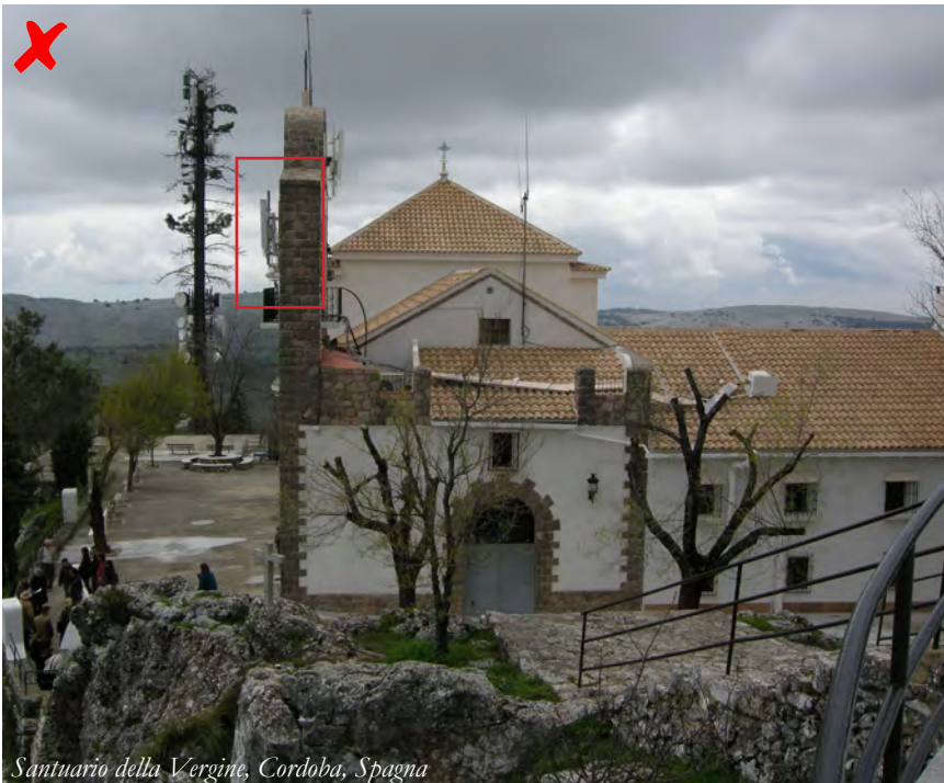
Fig. 44 - Criteri di localizzazione: la collocazione su edifici storici, vincolati o di particolare rilevanza per la percezione sociale va, generalmente, evitata a meno di una totale integrazione con il manufatto, grazie all'uso di tecnologie innovative che ne garantiscano la non visibilità. In ogni caso vanno minimizzati il più possibile tutti gli elementi accessori e adottato un generale criterio di ordine. (foto: Lionella Scazzosi)
