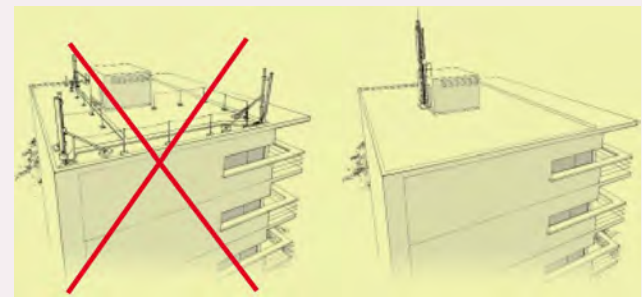
Fig. 65 - Continuità: le nuove installazioni devono dare l'impressione visiva di fare parte dei tetti e delle terrazze che le ospitano. In tal senso sono da evitare installazioni sul bordo della terrazza con l'utilizzo di bracci e strutture accessorie, mentre più appropriate sono collocazioni al centro del tetto addossate a vani tecnici e ascensori.
