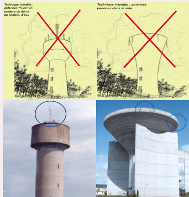
Fig. 68 - Collocazione su torri dell'acqua: nella disposizione di nuove antenne su torri dell'acqua bisognerà perseguire il principio della maggiore integrazione possibile con il manufatto che fa da supporto, utilizzando gli espedienti già visti in relazione alle facciate degli edifici. È bene, pertanto, evitare, ad esempio, una collocazione "nuda" delle antenne, ovvero priva di sfondo o in cui risultino pendenti dal coronamento. Più opportune sono collocazioni lungo il coronamento o in posizione centrale.
