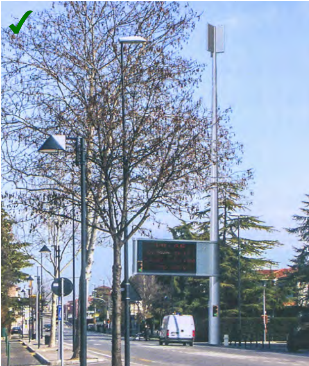
Fig. 50 - Design: le antenne possono essere adeguatamente alloggiate all'interno di elementi di arredo urbano quali lampioni o cartelli di segnaletica stradale. (foto: Briatore, 2005; calzavara.it)
