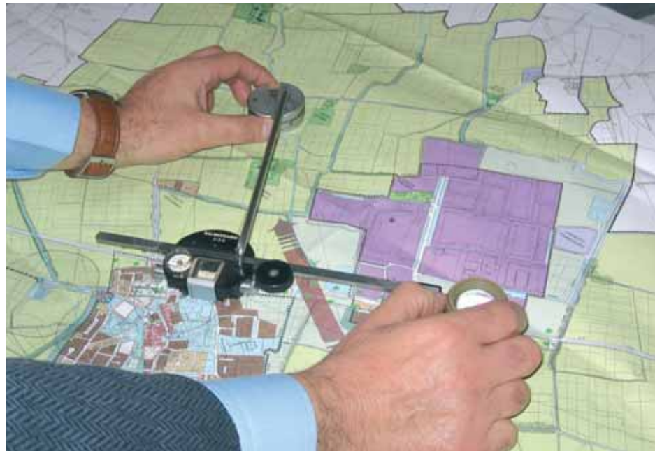
Un planimetro settecentesco e un planimetro polare utilizzato in passato presso il Centro Studi PIM
